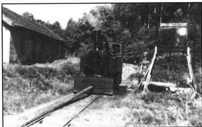
Chaque wagonnet était attelé au suivant et au précédent, ainsi qu'à la locomotive par une longue perche de bois frettée et munie d'un attelage à chaque extrémité. Ci-dessous : longue perche à l'attelage de la locomotive. Cette dernière "fait l'eau".
